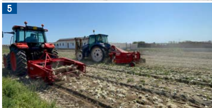
4. Prova di trapianto meccanizzato: la macchina trapiantatrice lavora su sei file con tre operatori (foto Romaniello) 5. Prova di raccolta meccanizzata: la macchina raccogliitrice lavora in tandem con la macchina per il topping (foto Romaniello)
