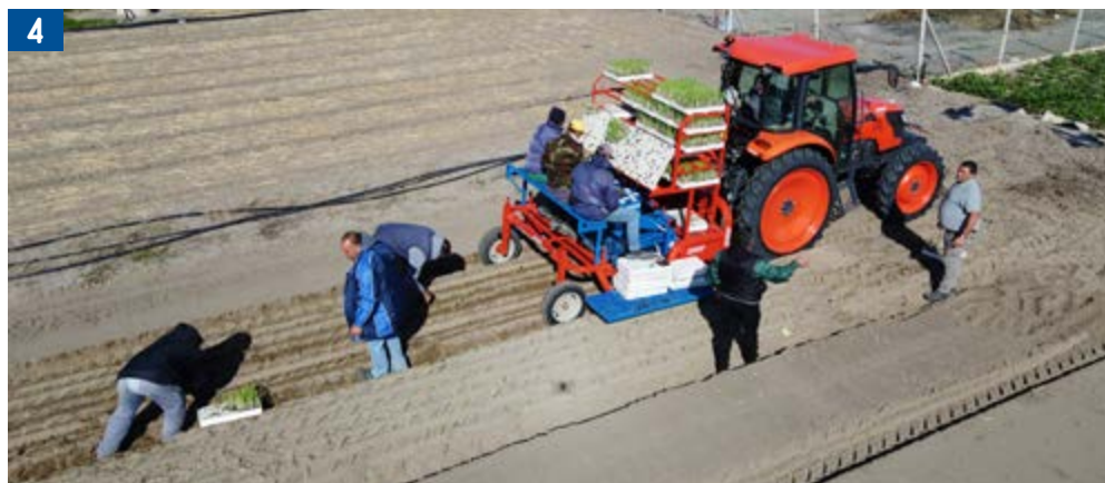
4. Prova di trapianto meccanizzato: la macchina trapiantatrice lavora su sei file con tre operatori (foto Romaniello) 5. Prova di raccolta meccanizzata: la macchina raccogliitrice lavora in tandem con la macchina per il topping (foto Romaniello)
